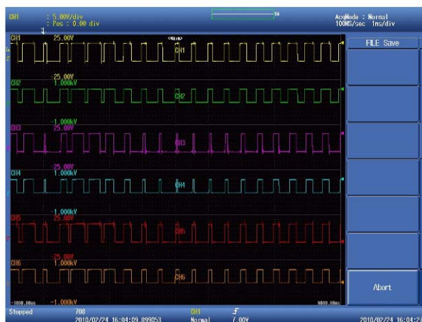
図8 インバータ波形測定例
